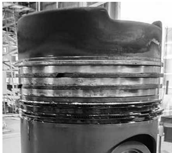
図-7 ピストンの開放状況
