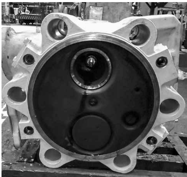
図-8 シリンダヘッド触火面の状況
