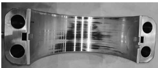
図-9 クランクピンメタルの開放状況
