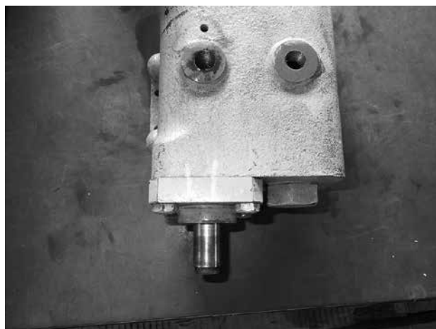
写真-2 停止シリンダが作動した状態
