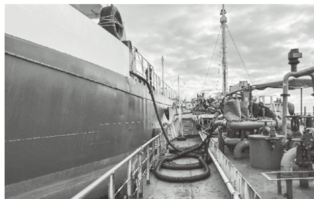
図-3 バンカリング船から対象船舶へホース接続
