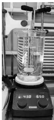
図-5 動粘度計測の様子
