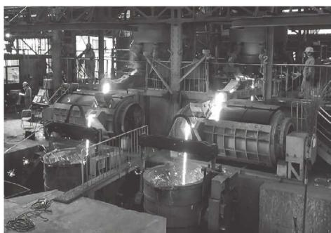
稼働中の冷風水冷式6t/hキュポラ2基
