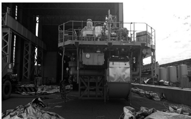
J-ENG殿UEC42LSH形機関 シリンダブロック外観
