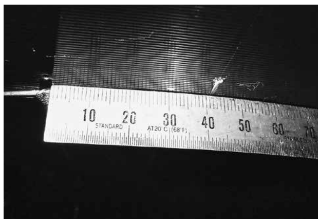
クランクアームとジャーナル軸のすべり幅
