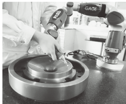
写真-2 石定盤の上で円錐形状の測定
