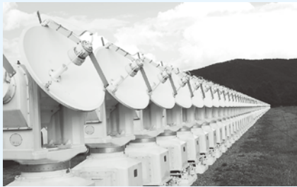
電波ヘリオグラフアンテナ：84 台
