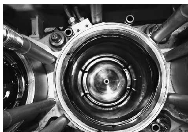
図-5 AX33B形機関のボアクーリングライナとAPリング
