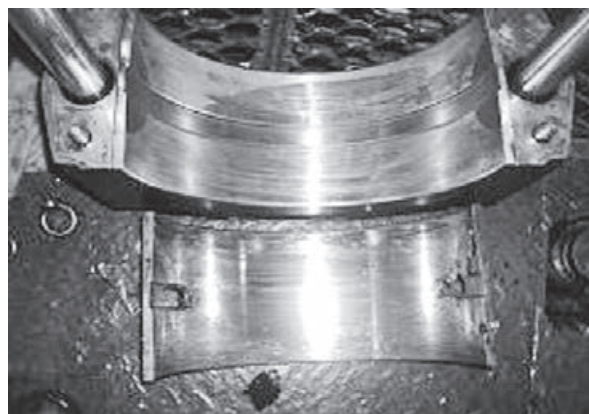
クロスヘッド上部の潤滑油穴から異物が混入し クランクピンメタルが損傷
