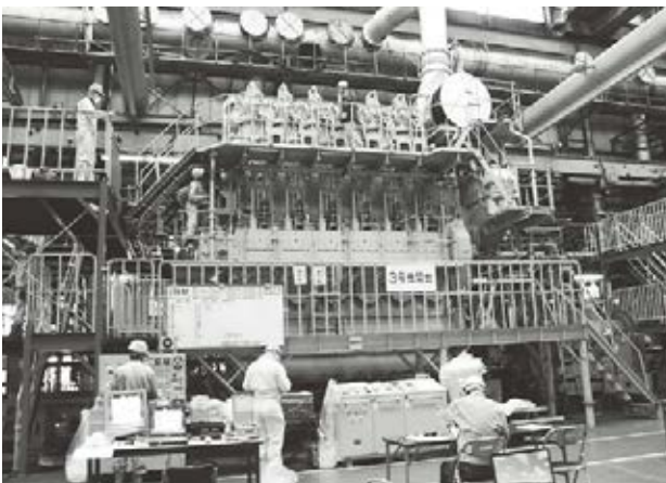
NK殿お立会いによる6UEC43LS II形機関のNOx鑑定受検
