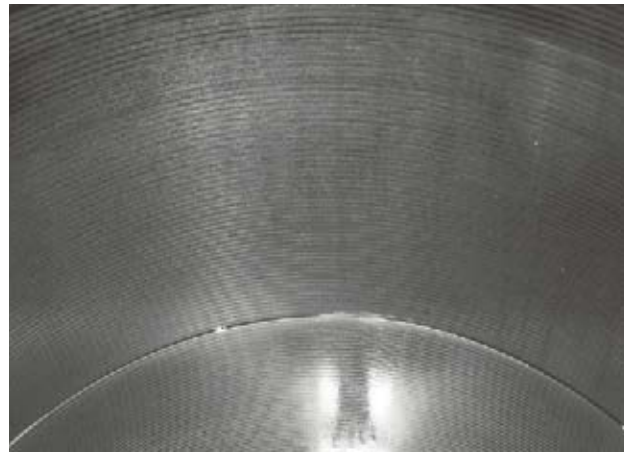
写真-2 シリンダライナ上部壁面
