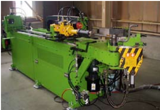
エンジンの血管であるパイプの成型用CNCパイプベンダー
