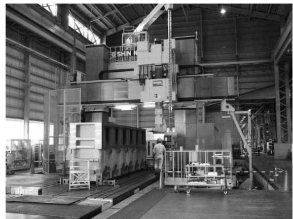
UEC52LS シリンダジャケット加工中
