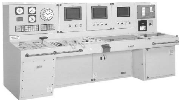
写真-1 制御盤への組み込み例
