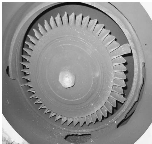
図-1 オーバーランにより引きちぎられたブレード
