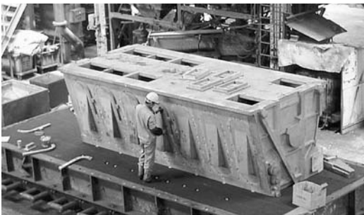
型込途中の37LSⅡ クランクケースの木型
